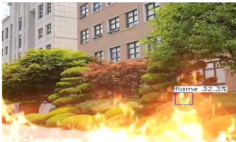
<그림 3> YOLOV4-tiny를 활용한 화재 탐지
